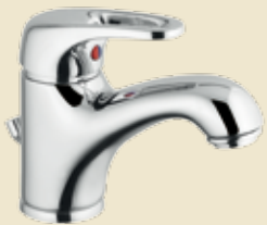
500099 _ _ Miscelatore monocomando lavabo flessibili inox G3/8", con scarico 1"1/4 con astina. Single lever basin mixer, G3/8" stainless steel flexible hoses, with 1"1/4 pop-up waste.
