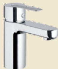
500045 __ Miscelatore monocomando lavabo flessibili inox G3/8", senza scarico. Single lever basin mixer, G3/8" stainless steel flexible hoses, without waste.
