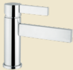
500014 _ _ Miscelatore monocomando lavabo, flessibili inox G3/8", senza scarico. Single lever basin mixer, G3/8" stainless steel flexible hoses, without waste.
