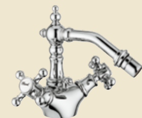
600015 _ _ Miscelatore tradizionale bidet, flessibili inox G3/8", con scarico 1"1/4 con astina. One hole bidet mixer, G3/8" stainless steel flexible hoses, with 1"1/4 pop-up waste.
