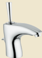
500088 _ _ Miscelatore monocomando lavabo, flessibili inox G3/8", con scarico 1"1/4 con astina. Single lever basin mixer, G3/8" stainless steel flexible hoses, with 1"1/4 pop-up waste.
