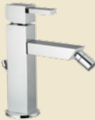
600040 _ _ Miscelatore monocomando bidet, flessibili inox G3/8", con scarico 1"1/4 con astina. Single lever bidet mixer, G3/8" stainless steel flexible hoses, with 1"1/4 pop-up waste.
